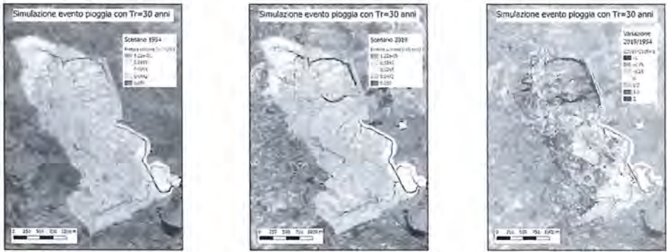
Figure 5 - Results of hydraulic modelling: 1954 and 2019 urbanisation scenarios and hydraulic invariance index Fig. 5 - Risultati della modellazione idraulica su scenari di urbanizzazione del 1954 e 2019 e indice di invarianza idraulica
