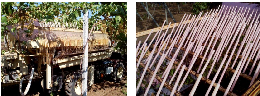
Fig. 2. Macchina vendemmiatrice e particolare dei pettini oscillanti.
