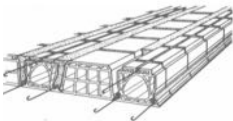
Fig.01 | Solaio tipo "Cirex" (rif. AA.VV., "Manuale dell'architetto", compilato a cura del Consiglio Nazionale delle Ricerche, Roma, 1946).
