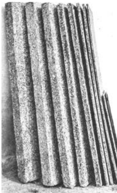
Fig.108 | Serie completa dei diversi spessori prodotti di lastre Eraclit, in "DOMUS" n.55, Luglio 1932, pag.69
