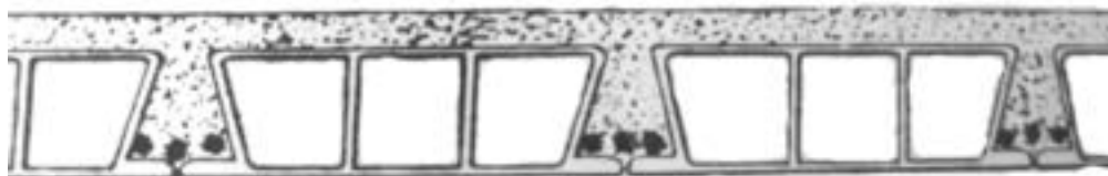
Fig.01 | Solaio tipo "Cannovale e Dellepiane" (rif. Formenti C., "La pratica del fabbricare", Hoepli, Milano 1893).
