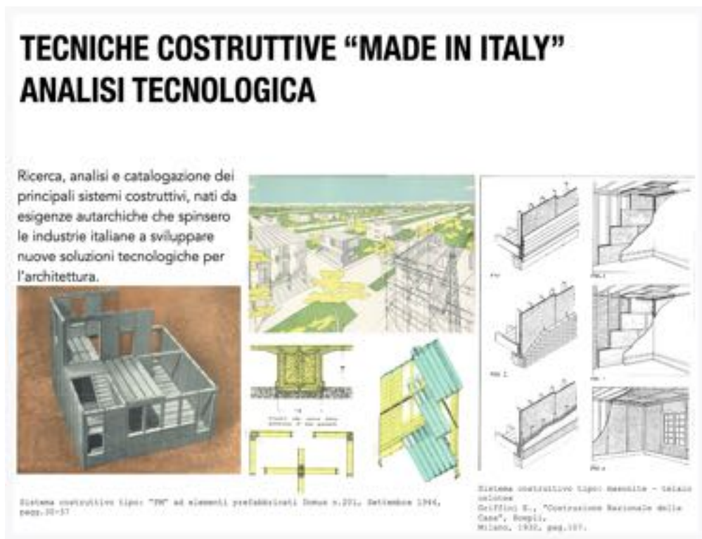
Fig.17 | Esempi di alcuni sistemi costruttivi brevettati dalle industrie italiane nel periodo fra le Due Guerre, sotto la spinta di politiche ed esigenze autarchiche. Tale documentazione tecnica costituisce un tassello fondamentale per l'analisi e la conoscenza delle architetture del primo Novecento in Italia.
