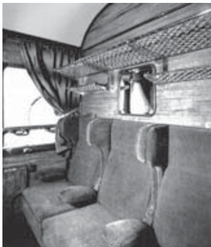
Rivestimento delle pareti di un vagone delle FESS. in linoleum e jaspè su pannelli di Albes, in "EDILIZIA MODERNA", n.17, Milano, Aprile-Giugno 1935, pag.7.
