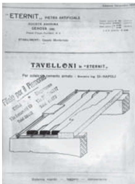
Tavelloni in Eternit (assonometria e vista di un cantiere con applicazione del sistema costruttivo) in Catalogo generale "ETERNIT PIETRA ARTIFICIALE - SOCIETÀ ANONIMA" Genova, 1928.
