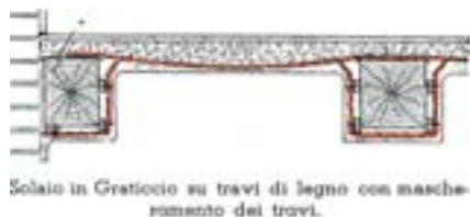
Solaio a platea in Graticcio su travi di legno.
