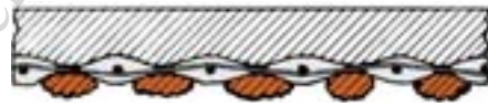
Sezione morfologica del Graticcio Stauss e passivazione del ferro di armatura, in "DOMUS", n.88, Aprile 1935.
