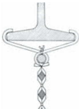
Fase 5b: fissaggio nelle costruzioni in ferro delle stuoie in Graticcio Stauss mediante ganci metallici a forma di S.
