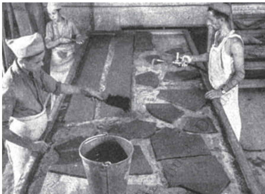
Processo manuale di lavorazione di singoli elementi in Eternit (archivio privato).
