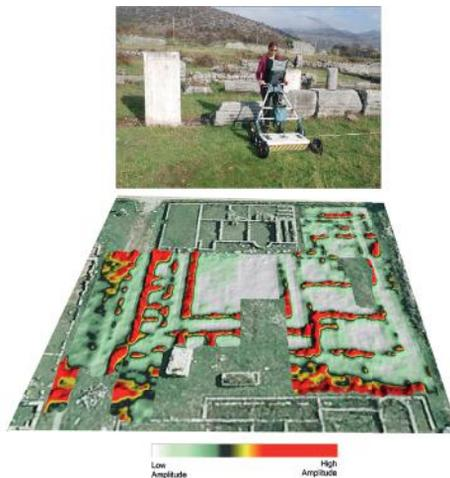
**Fig. 6.** *Acquisizione dati con Georadar RIS-K2 (in alto) e visualizzazione 3D dei risultati geofisici presso le terme (in basso).*
