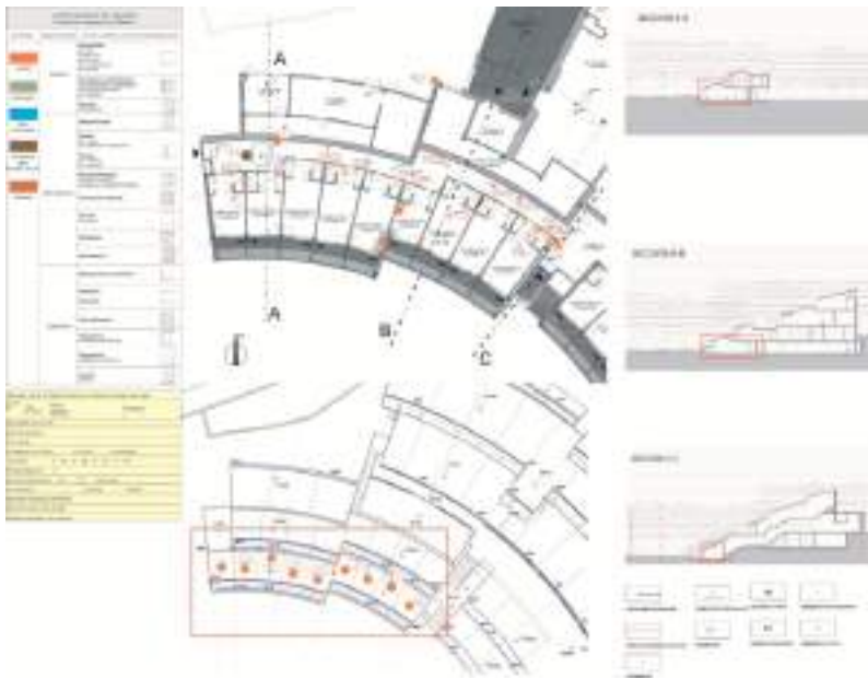
Imagen3. Mapa de lesiones, Planta Nivel-2 y Cubiertas, ala oeste. Planta y secciones.
