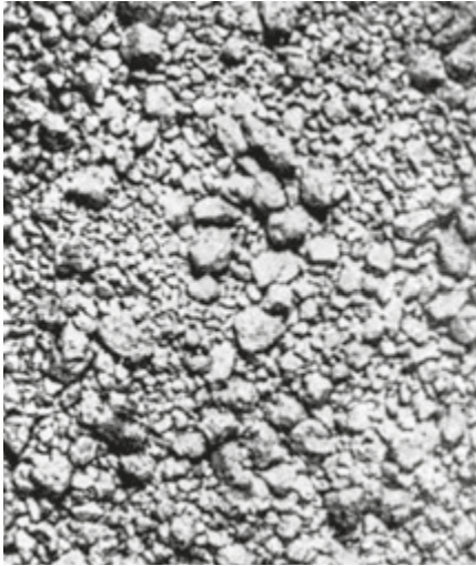
Immagine campione di Calcestruzzo di pietra pomice, in Griffini E., "Costruzione Razionale della Casa", IV edizione, Hoepli, Milano, 1947, pag.15.
