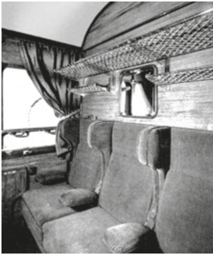
Rivestimento delle pareti di un vagone delle FESS. in linoleum e jaspè su pannelli di Albes, in "EDILIZIA MODERNA", n.17, Milano, Aprile-Giugno 1935, pag.7.
