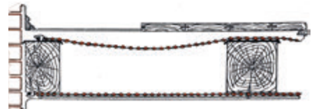
Solaio e plafone in Graticcio su travi di legno.
