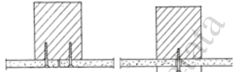
- Applicazioni di cemento-amianto su montanti di legno, senza e con copri-giunto.
