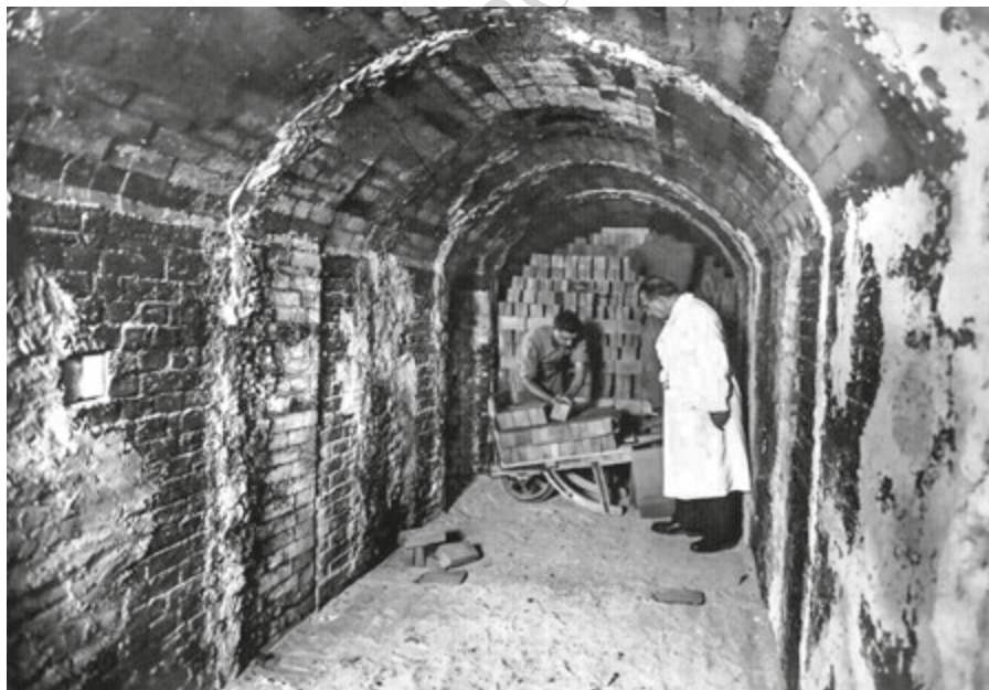
Carico dei mattoni refrattari a seguito delle fasi di cottura, raffreddamento e demolizione del 'voltino' in muratura e della porta di accesso. Immagine storica della Fabbrica Refrattari Verzocchi di La Spezia, (archivio sezione Unità Cura e Gestione delle Collezioni del Comune di Forlì).
