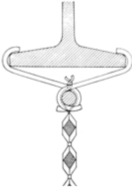
Fase 5b: fissaggio nelle costruzioni in ferro delle stuoie in Graticcio Stauss mediante ganci metallici a forma di S.
