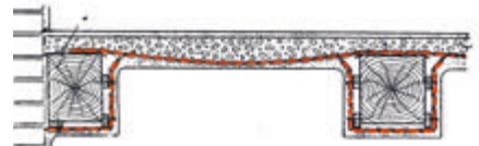
Solaio in Graticcio su travi di legno con mascheramento dei travi.
