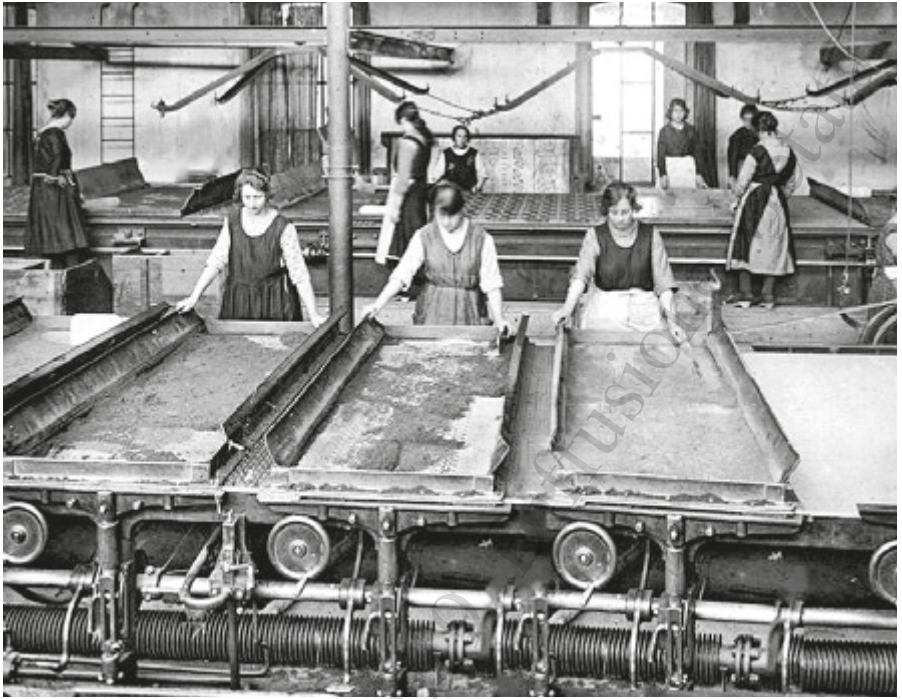
Operai della fabbrica di Linoleum di Giubiasco; diapositiva su vetro realizzata intorno al 1925. Processo di setacciatura della farina di legno e di sughero per la successiva fase di miscelazione con olio di lino e calandratura ad alta temperatura per l'ottenimento della stuoia di Linoleum.
