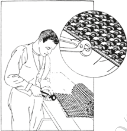
Fase 4: armatura delle stuoie in Graticcio Stauss.
