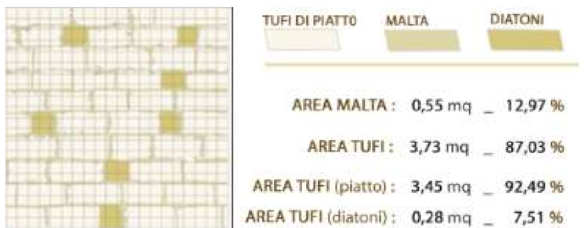
Figura 2 Analisi della tessitura muraria
