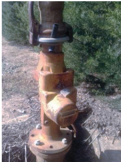
Figura 1. La rottamazione impianti irrigui è stata sostenuta in Basilicata con una misura dedicata (DGR 2059/2001). Si noti la presenza dell'impianto irriguo sovrachioma sostituito con quello localizzato (tubi in PVC); Sostituzione delle vecchie bocchette di erogazione (sinistra) con nuovi erogatori (destra) che consentono la contabilizzazione dei volumi irrigui prelevati operata in Consorzi irrigui della Basilicata (Tratto da Xiloyannis et al., 2015)
