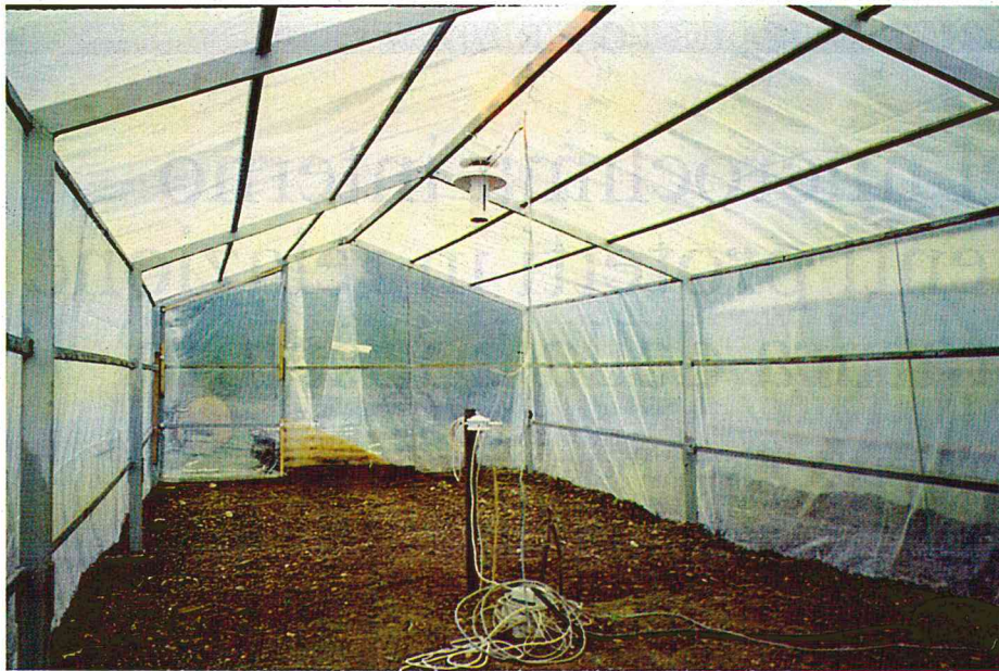
Fig. 1 - Veduta interna della serra sperimentale coperta con singolo film di TFE 90 con strumenti di rilievo dei dati.
