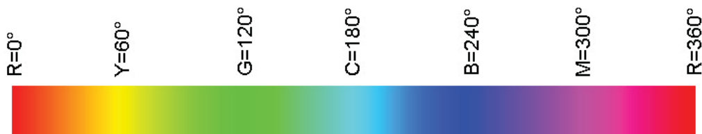
Figura 2.4: Colori primari e secondari definite dalla tinta H del sistema HSB
