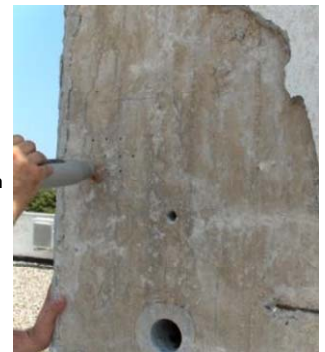
Figura 2. Griglia di punti utilizzata per la prova sclerometrica.
