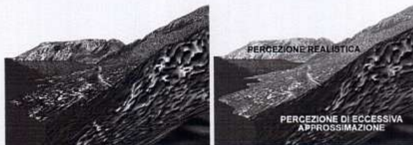
Fig. 6 - Vista del modello della costa tra Sapri e San Nicola Arcella con individuazione delle parti di percezione realistica e approssimata
