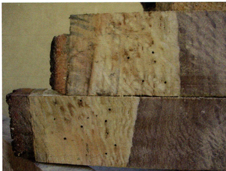
Foto 2. – Presenza di diffusi attacchi di insetti e funghi in corrispondenza dell'alburno.
