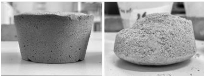
Figura 3. Limitata espansione (sinistra) e disgregazione (destra) dei campioni sviluppati nel corso della seconda campagna sperimentale [Fonte: autore].
