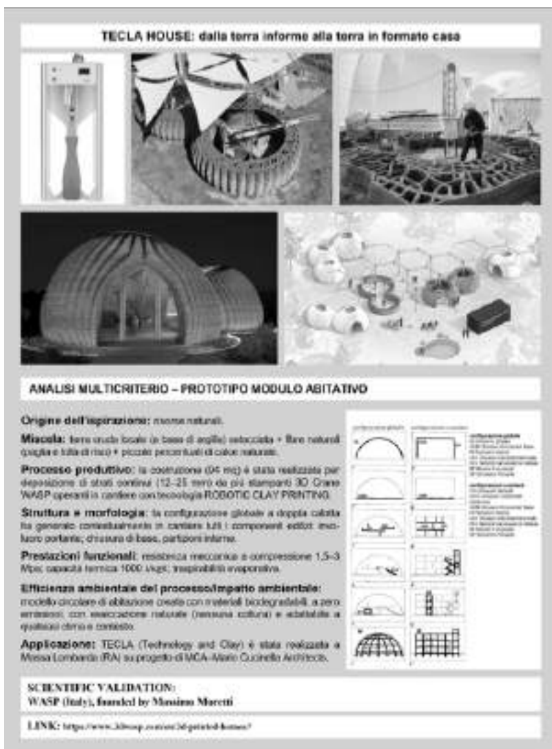
Figura 2. TECLA HOUSE: materiale di origine naturale + costruzione on-site + tecnologia ROBOT CLAY PRINTING. [Fonte: elaborazione degli autori].
