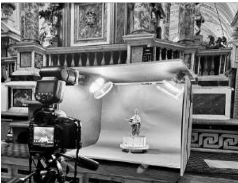
Figura 3. Allestimento per la turntable photogrammetry a polarizzazione incrociata della statuetta raffigurante Sant'Ambrogio (su disegno di Cosimo Fanzago, XVII secolo). Visibili la fotocamera su treppiede, le luci con i filtri applicati e il piatto rotante. [Fonte: foto degli autori].
