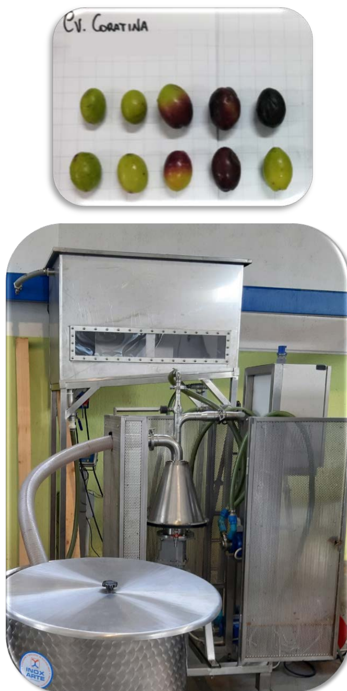
Fig. 7. In alto, foto delle impiegate nella sperimentazione. In basso foto dell'impianto di separazione installato in oleificio.
