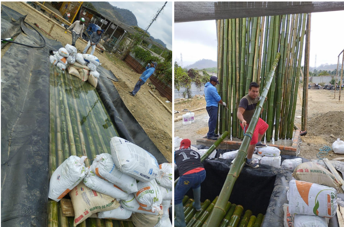
Preservado de Culmos de bambú en solución de bórax y ácido bórico
