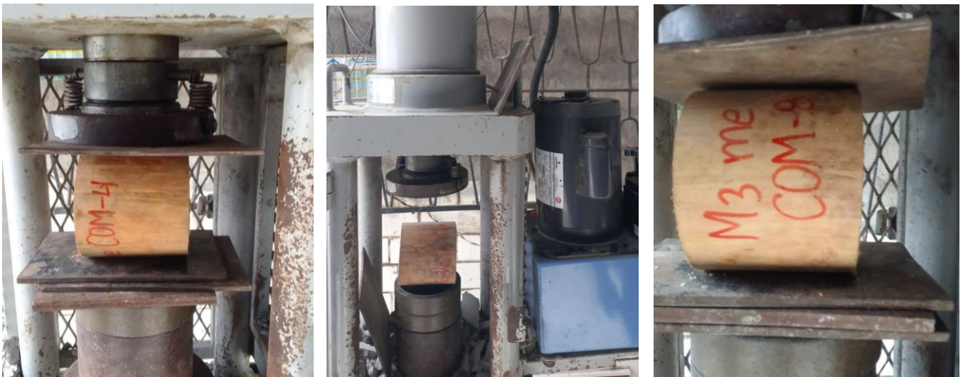
Figura 96 Muestra de probetas en ensayo de compresión. Fuente (Autor de esta investigación, 2023)
