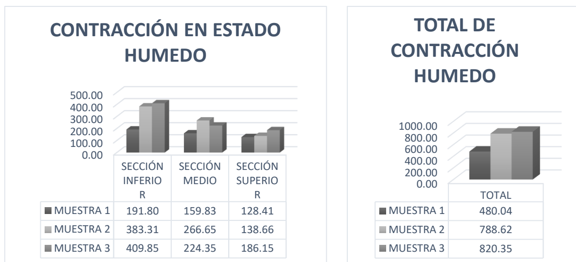
Figura 92 Análisis de los ensayos de contracción en estado húmedo de las muestras. Propiedades físicas. Fuente (Autor de esta investigación, 2023)
