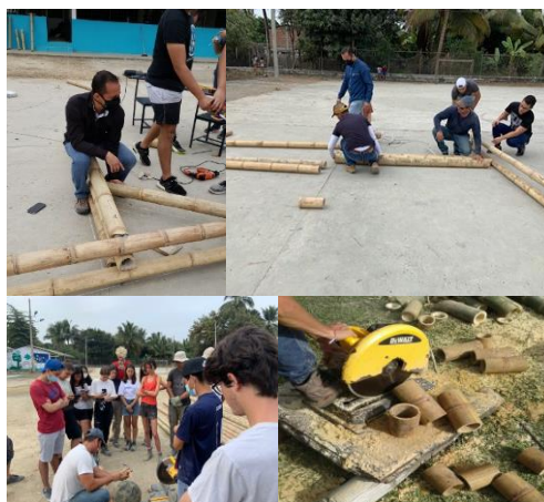
Figura 70 Toma de medidas y cortes de las muestras para los ensayos. Fuente: (Autor de esta investigación, 2023)
