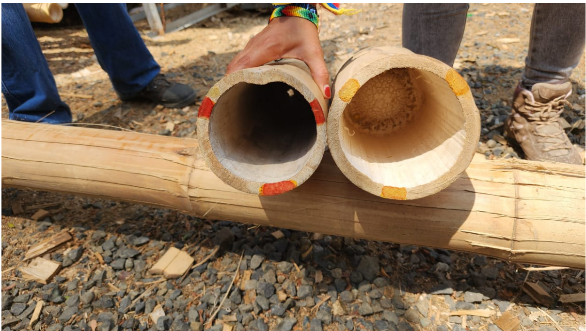
Prueba de curcua para comprobar la calidad del preservado, lazo izquierdo, culmo de bambú preservado, dado derecho, culmo de bambú sin preservar
