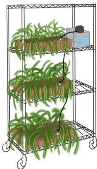
Figura 2 - Schema di progettazione di una parete verde mobile per il monitoraggio delle polveri sottili in una stalla per bovine da latte.
