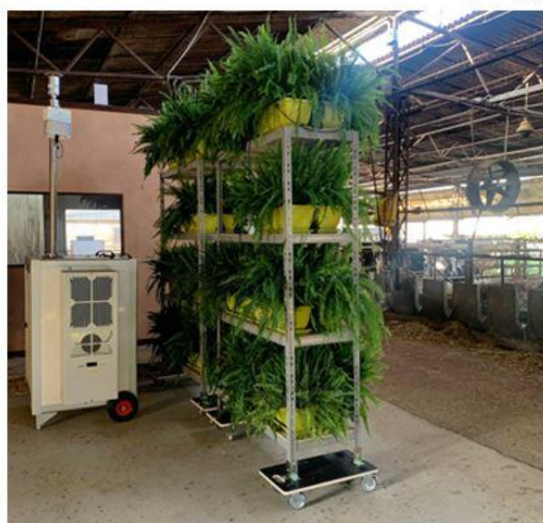
Figura 2 - Schema di progettazione di una parete verde mobile per il monitoraggio delle polveri sottili in una stalla per bovine da latte.
