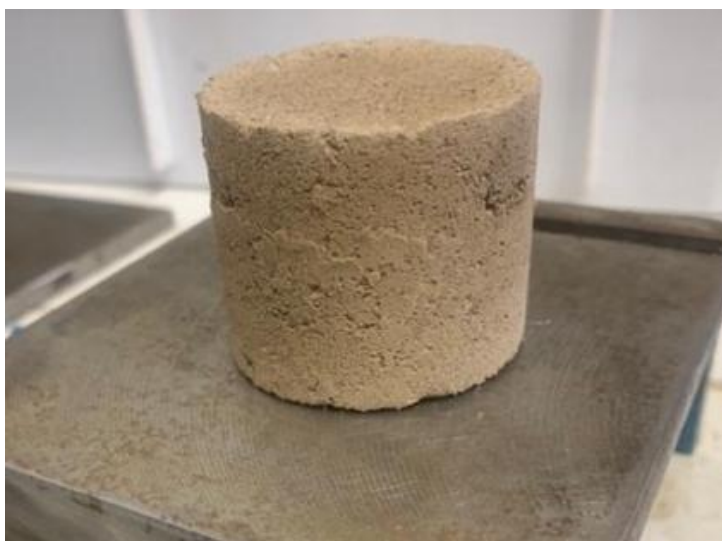
Figura 5 - Esempio di campione cilindrico in terra cruda e vinacce utilizzato per la caratterizzazione meccanica e fisica
