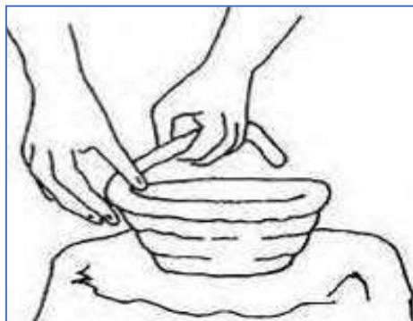
Figura 3.1.1- Modellazione con la tecnica "a colombino" (Carratoni 2015)
