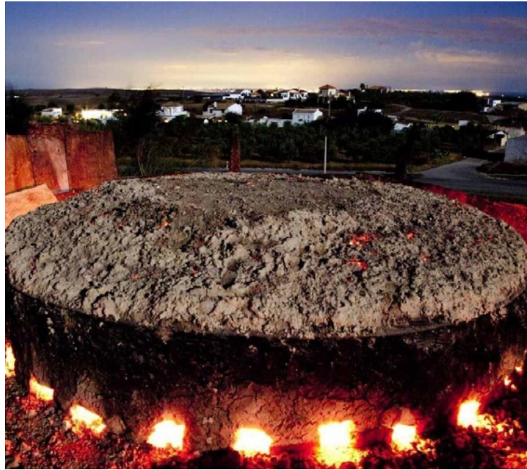
Fig. 4. La fase di cottura della calce nel forno tradizionale di Morón de la Frontera (Siviglia) con la fiamma da combustione di legno di ulivo che fuoriesce dalle bocche di aerazione, offre uno spettacolo di grande suggestione. Il sito fa parte di un itinerario di turismo industriale andaluso volto alla riscoperta delle antiche tecniche di produzione della calce.
