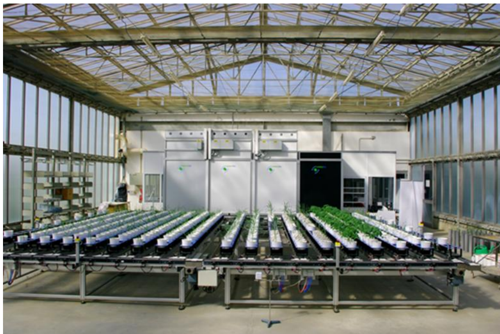
Fig. 8 Piattaforma Scanalyzer 3D (LemnaTec GmbH) utilizzata per il phenotyping automatico presso il CRMA ALSIA.
