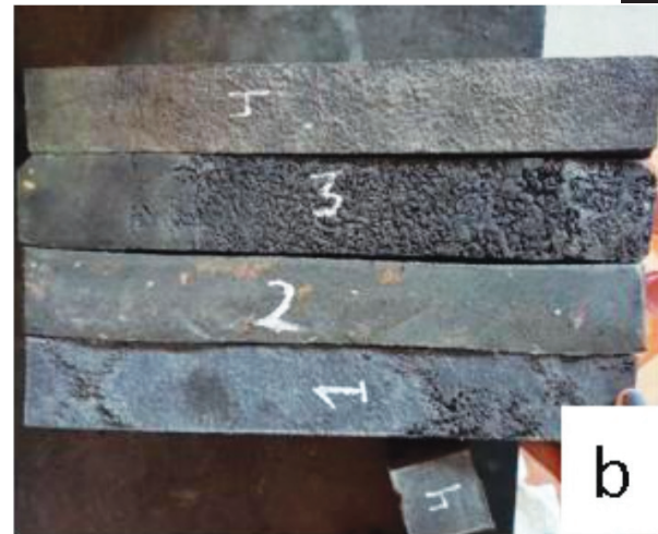
Fig 8. Especímenes de las placas de polímeros más fibra de coco, Fig. 8a muestras para ensayos de resistencia a la compresión. Fig. 8b muestras para ensayos de resistencia a la flexión.
