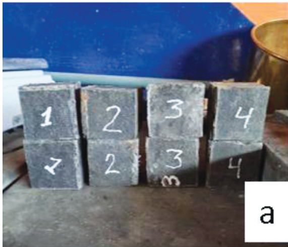
Fig 8. Especímenes de las placas de polímeros más fibra de coco, Fig. 8a muestras para ensayos de resistencia a la compresión. Fig. 8b muestras para ensayos de resistencia a la flexión.
