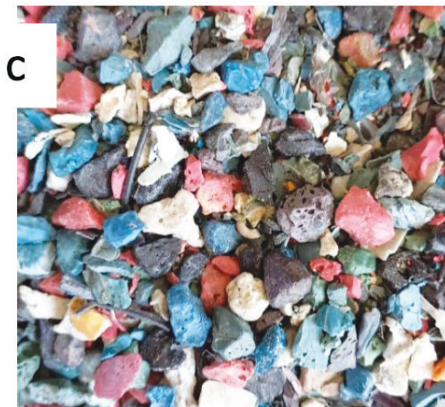
Fig 1. : Fig 1a Polietileno de baja densidad, residuos industriales de la elaboración de fundas plásticas, Fig. 1b Polietileno de alta densidad, residuos industriales de la elaboración de botellas de agua, bidones, Fig. 1c Polipropileno de inyección, residuos industriales de la elaboración de sillas, mesas, tinas plásticas.
