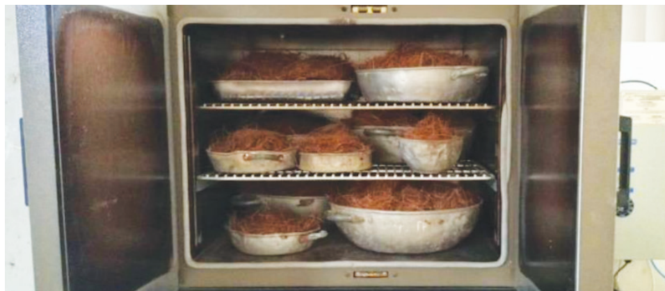
Fig 1. Secado de la fibra de coco en horno.
