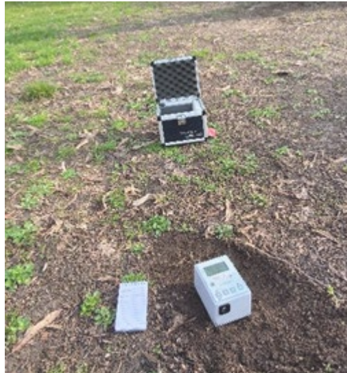
Figura 2.16 – Tromografo digitale TROMINO utilizzato per le registrazioni.
