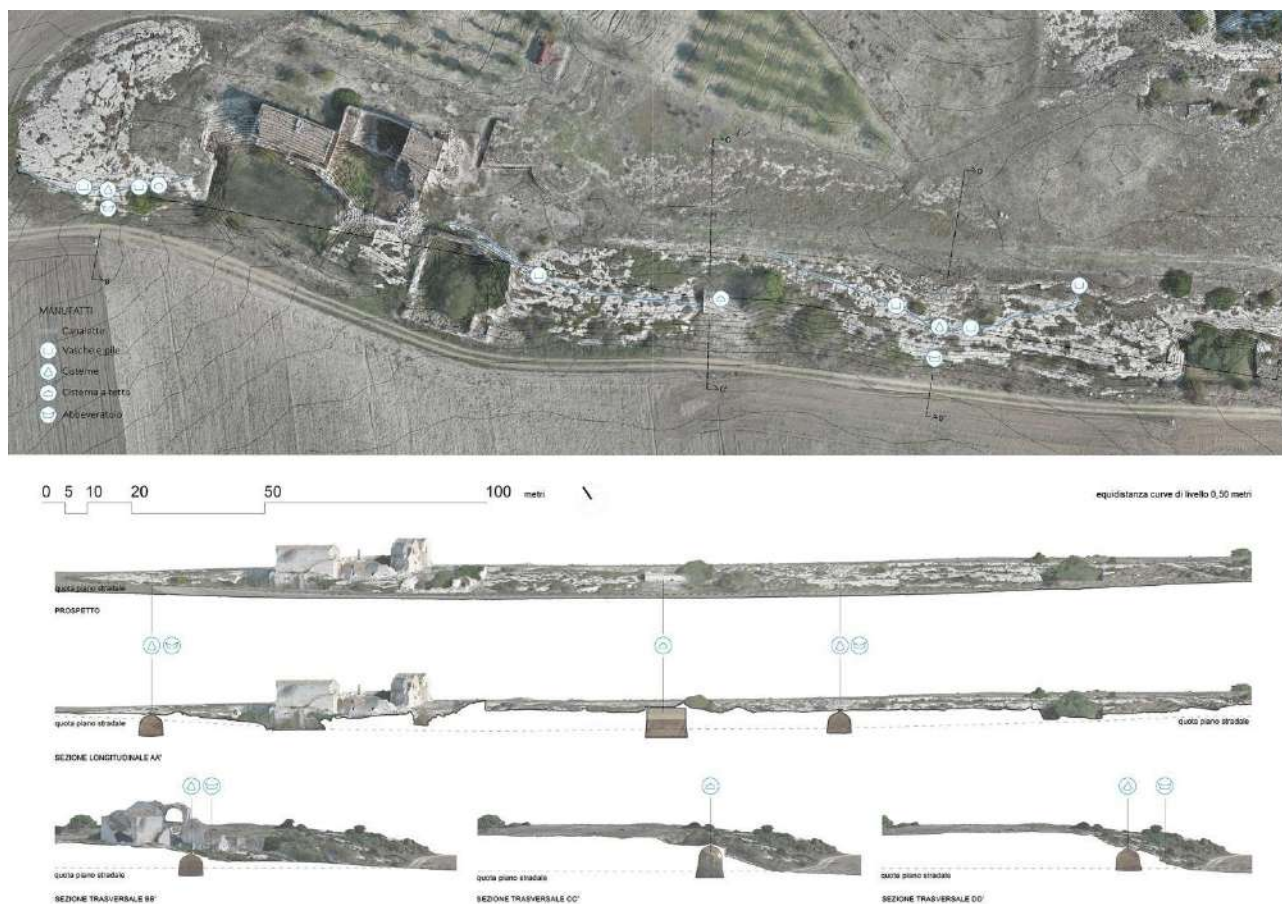
Fig. 4. Pianta, prospetti e sezioni dell'area della Masseria del Cristo e dei suoi sistemi integrati di gestione delle risorse idriche.
