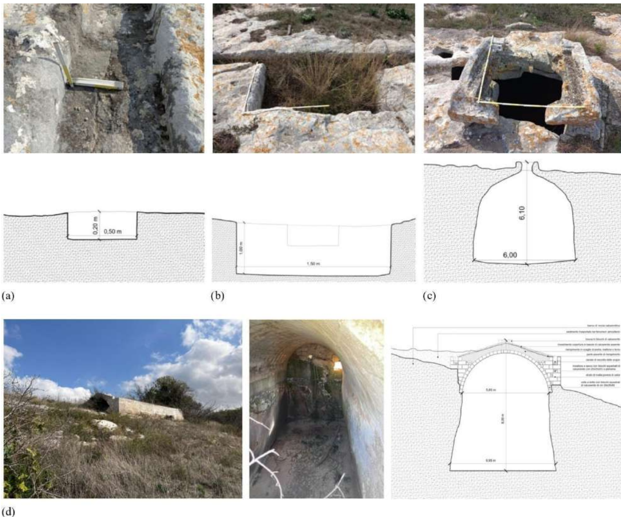
Fig. 5. Fotografie e sezione tecnologica di (a) canale scavato, (b) vasca di decantazione scavata, (c) cisterna "a campana" e (d) cisterna "a tetto".
