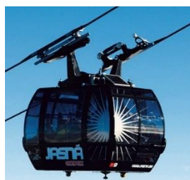
Figura 10: Sistema Funitel 3 caratterizzato da due funi (entrambe con funzione portante e traente) in moto unidirezionale, costituite da un unico anello impalmato, alle quali sono agganciate temporaneamente più cabine.
