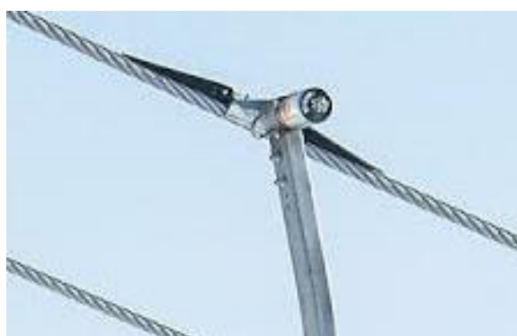
Figura 5: Morsa fissa per agganciamento permanente dei veicoli
