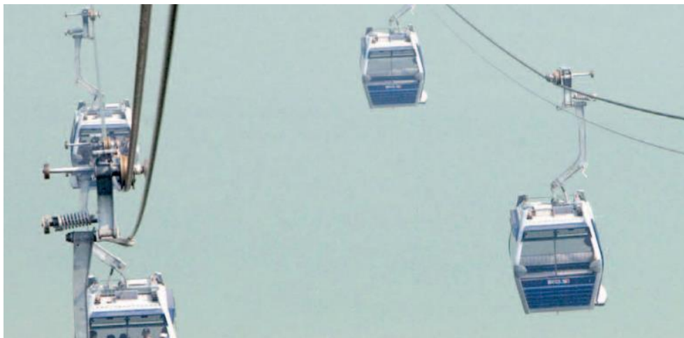
Figura 9: Sistema 2S 1 caratterizzato da una fune portante ed una traente in moto continuo
