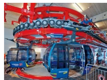
Figura 10: Sistema Funitel 3 caratterizzato da due funi (entrambe con funzione portante e traente) in moto unidirezionale, costituite da un unico anello impalmato, alle quali sono agganciate temporaneamente più cabine.
