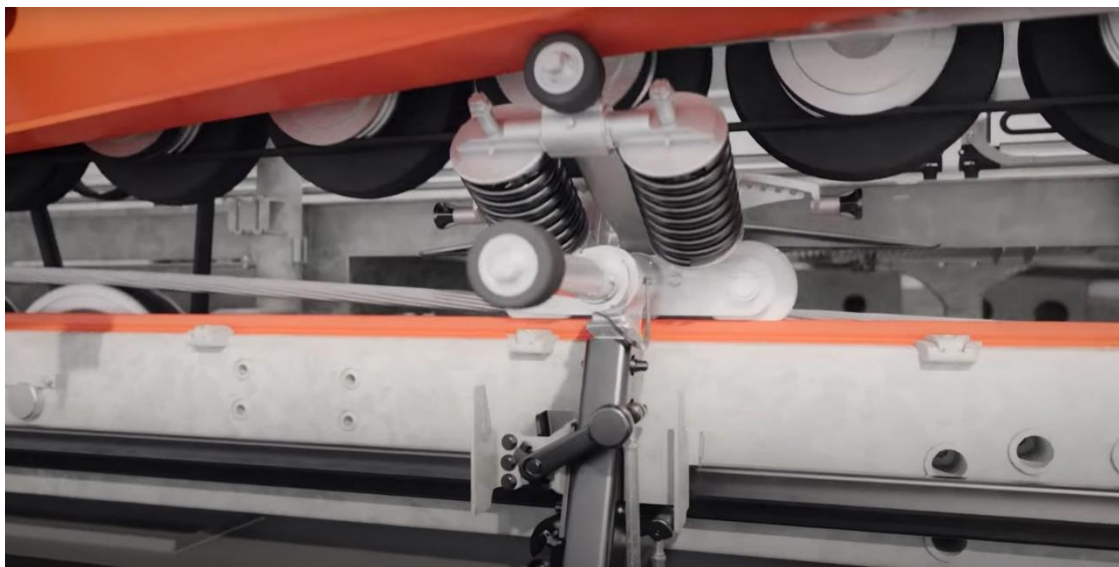
Figura 7: Dispositivo per l'apertura e la chiusura delle morse in stazione
