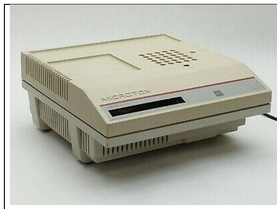
Figura 30 – Luminometro M500 utilizzato nei test (Foto AZUL Environmental. Strategic Diagnostics Inc. Newark, USA)
