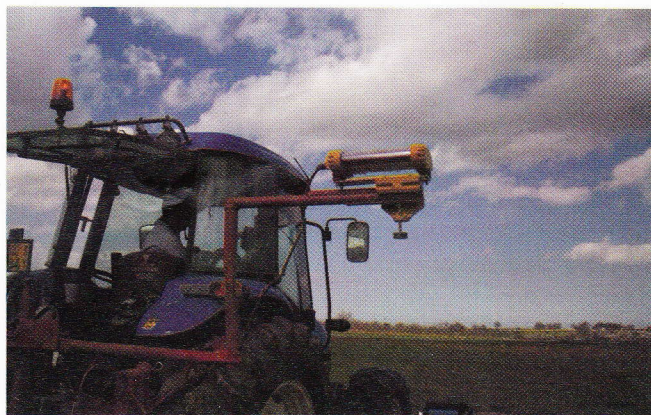
&gt;&gt; 3. Ricevitore posto sulla trapiantatrice.
