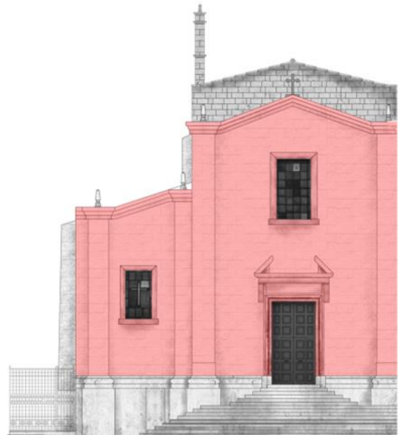
Figura 5. Ribaltamento semplice della facciata.
