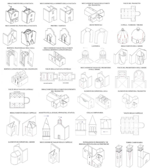
Figura 4. Meccanismi di collasso secondo le Linee Guida 2010.
